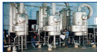
Fig. 13. Evaporador de placas de tres efectos
