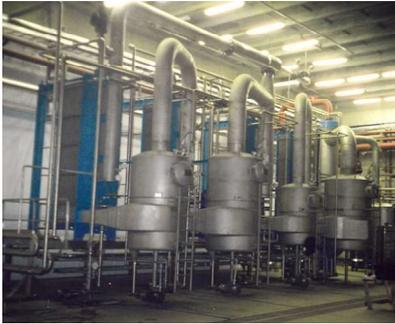
Fig. 15. Evaporador de placas de cuatro efectos
